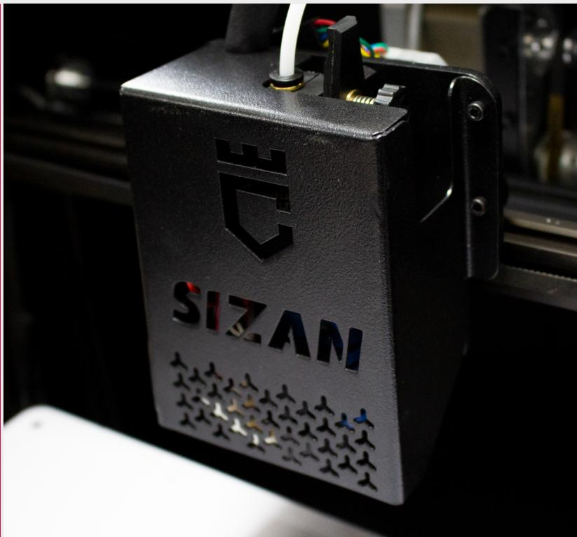
اکسترودرهای دو چرخ دنده به واسطه بهره گیری از دو چرخ دنده برای فشار دادن رشته ی فیلامنت به سمت نازل علاوه بر سرعت و قدرت بیشتر، کنترل حرکتی بهتری را برای قسمت کنترلی دستگاه جهت تنظیم میزان مواد خارج شده از نازل فراهم می کنند.
